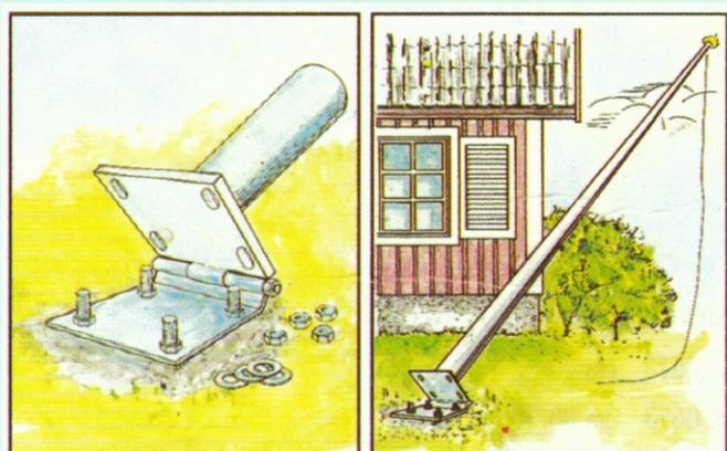
I pennoni di 14-16 metri vanno montati su una piastra a cerniera, in ferro zincato a caldo.
